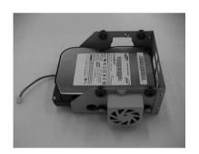
5. 付属品の特殊ネジ (BWH、6-32UNC、L10.5) (4箇所) を使用して、HDDをHDDブラケットに取り 付けます。(ネジは、振動で緩まないようにしっかりと締めます。)
